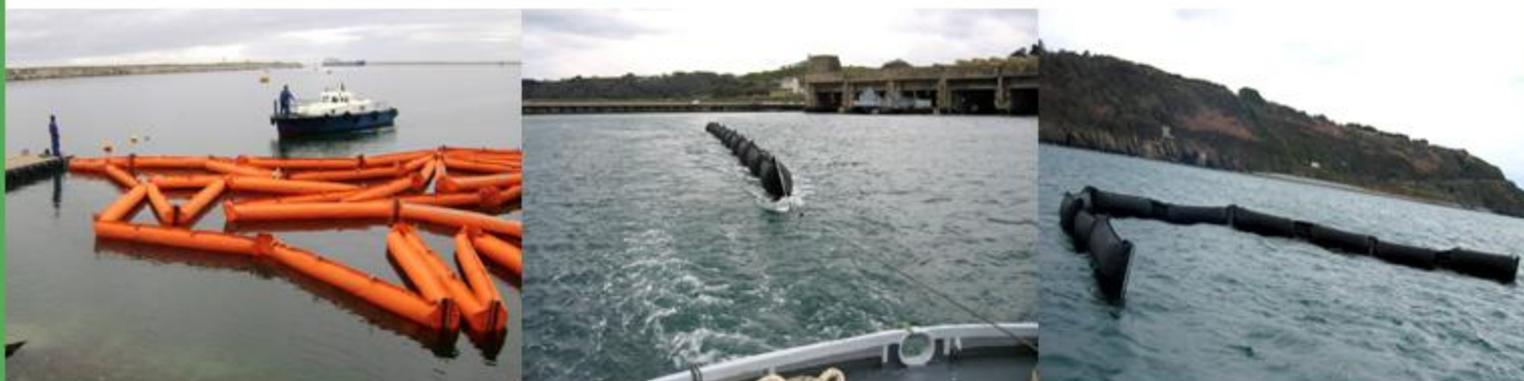
**Боны морские надувные БМ** применяются для локализации аварийных разливов нефти, нефтепродуктов, масел, ГСМ в тяжелых морских условиях. Оболочка («рубашка») бона БМ изготовлена из прочного износостойкого неопрена черного цвета, армированного полиэстером. Материал надувного бона устойчив к воздействию морской воды (солевому составу), ультрафиолетовому излучению, нефти и нефтепродуктов, микроорганизмам и не подвержен гниению.
