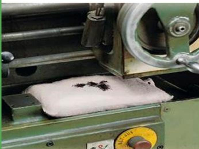
*Гидрофобные сорбирующие подушки используются в профилактических мерах, для предотвращения проливов из кранов, клапанов, нефтепроводов, арматуры и других проблемных мест, где возможна утечка опасных жидкостей. Подушки могут использоваться в экстренных случаях для сбора нефтепродуктов с поверхности воды и земли.*
