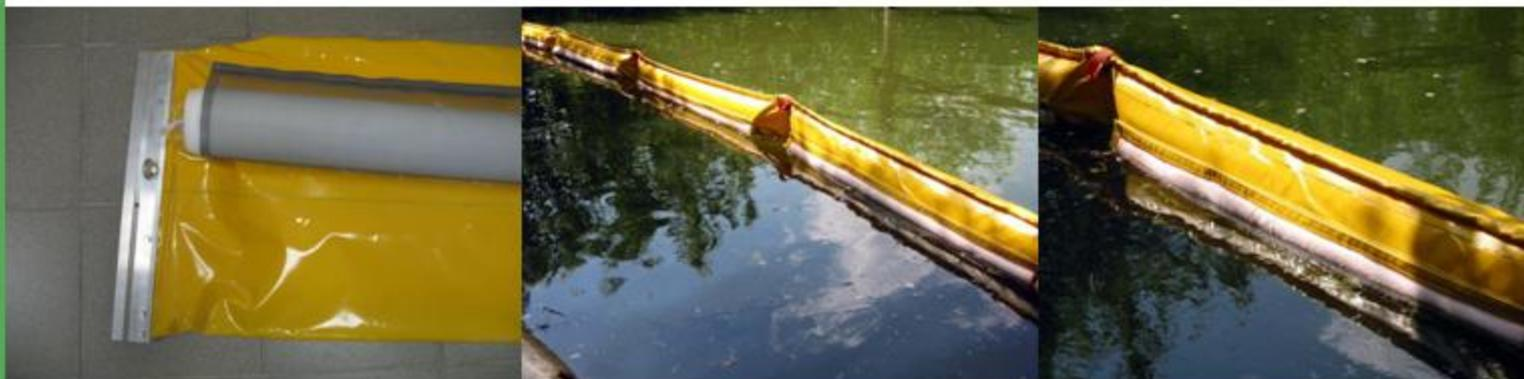
**Применение:** для локализации и сорбирования аварийных разливов нефти, нефтепродуктов, масел и ГСМ с водной поверхности, а также для предупреждения их дальнейшего распространения. С помощью сорбирующих бонов БЗс можно «перетаскивать» нефтяные пятна к нефтесборным пунктам траловыми устройствами и защищать береговые линии от загрязнения аварийных проливов нефтепродуктов.
